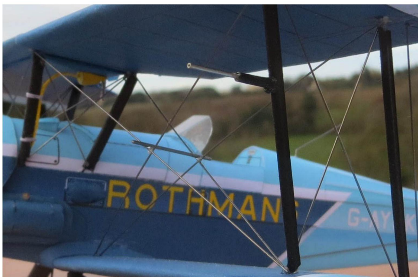
Corde à piano de 3/10mm pour ce STAMPE SV4 c au 1/33
